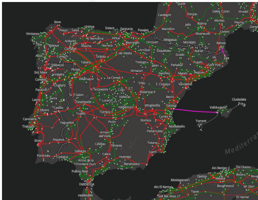
Mapa 20. Líneas de transmisión para voltaje de 220kV y superior y estaciones de generación con capacidad de generación neta superior a 100MW.
