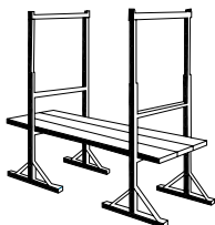
Fig. 2. Andamio de borriquetas verticales
